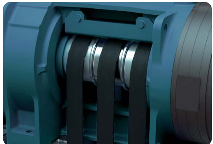
Взаимодействие плоского ремня и гладкого бочкообразного шкива
